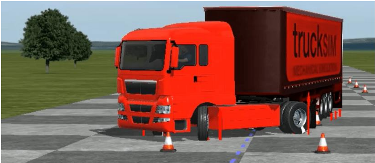
Bild 5. Modell av dragbil med lättglidande vändskiveyta "körs" på simulerad "vägbana" jämn som ett salsgolv i "standardmanöver" (häftig körfältsväxling) med snabbrattande "förare" (blixtsnabb styrreaktion till fullt rattutslag för att stoppa fällknivsrörelsen).
