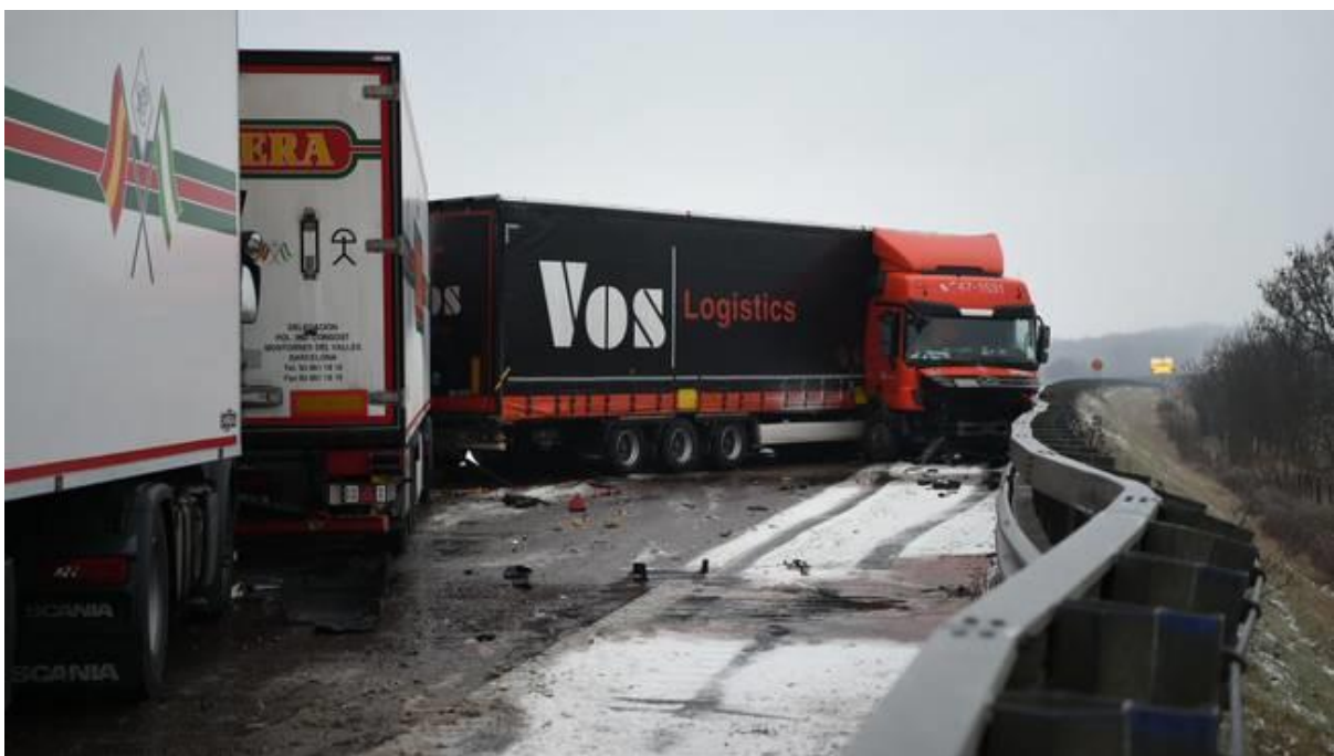
Bild 6. Verklig dragbil med saltkorroderad vändskiveyta har kört om tre andra EU-tradare på verklig vinterväg med uppemot 5 gånger högre friktionstal på barmarken än i snömodden.
