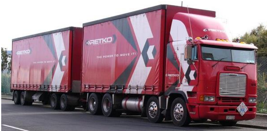
Dubbla styraxlar ger bättre styrbarhet vid halt väglag. Bildkälla
