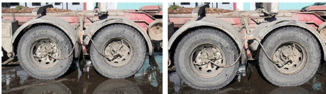
Lägre lufttryck i däcken ger större däckavtryck och lägre marktryck, vilket ger minskat vägslitage
